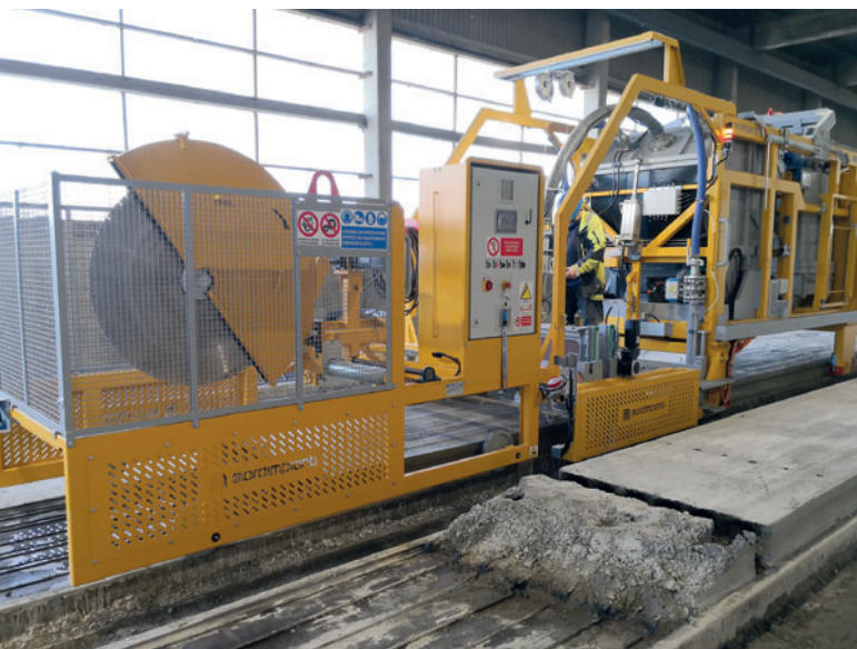
Автоматическая пила в сочетании с бетонным аспиратором для работы со свежим бетоном
